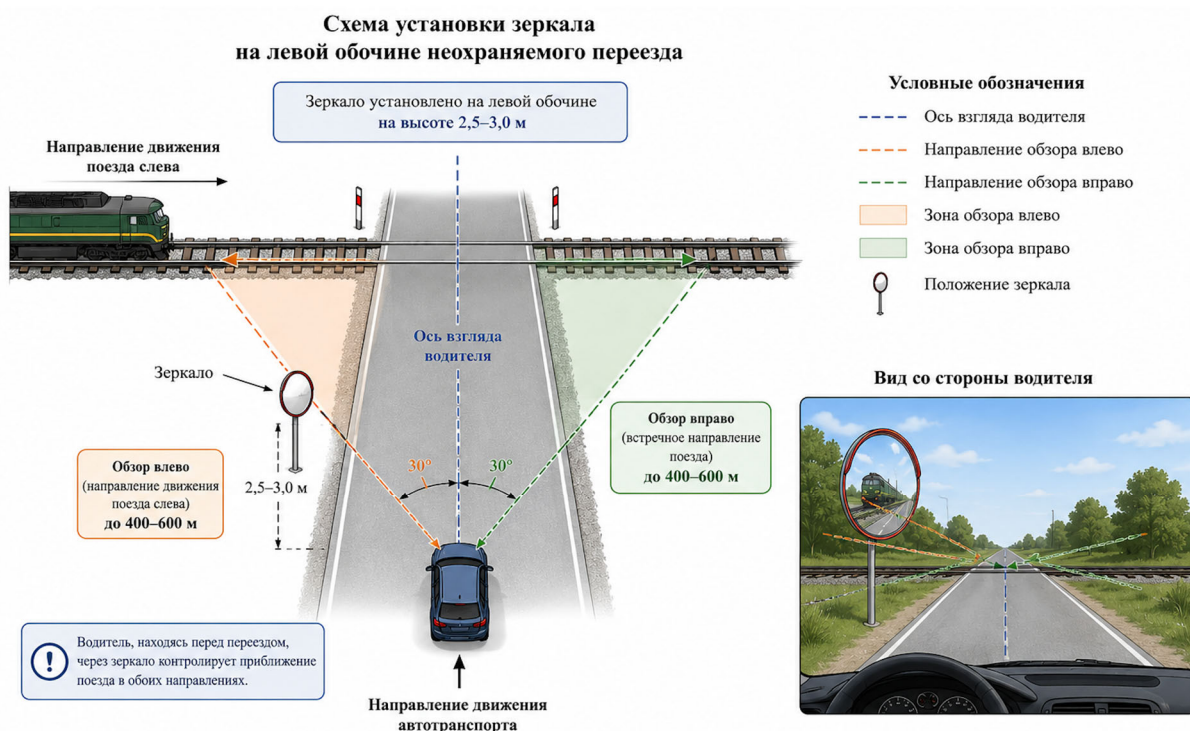
Рис. 5. Схема установки зеркал на переезде
