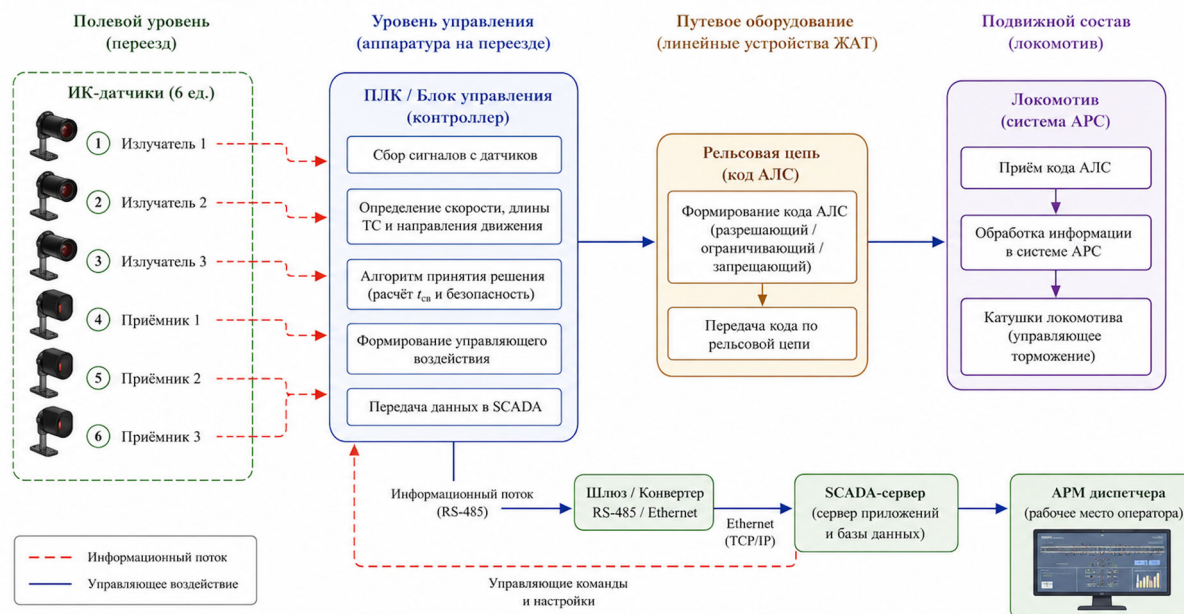
Рис. 7. Функциональная схема интеграции системы ИК-датчиков с АЛС-APC и SCADA
