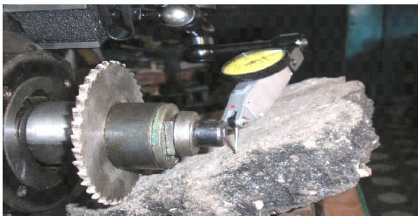
Рис. 1. Процедура замера деформаций образца асфальтобетонного покрытия с помощью универсальной магнитной измерительной головки.
