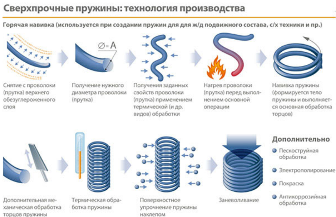
Рис. 1. Алгоритм технологии производства сверхпрочных пружин для подвижного состава (ПС) и путевых машин (ПМ) (Перевертов, 2022: 41).
