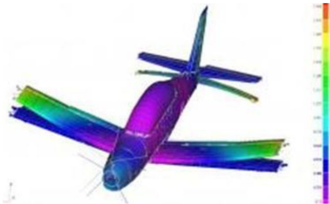
Рис. 5. Проекция нагрузки самолета в MSC
