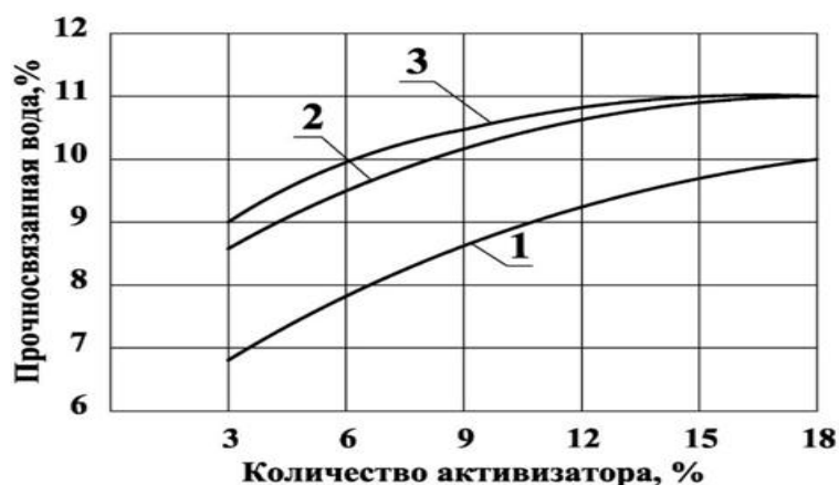
Рисунок 4 – Кинетика изменения содержания прочно связанной воды в процессе твердения шлакового вяжущего при нормальных условиях: 1 – образцы, твердевшие 1 месяц; 2 – соответственно 3 месяца; 3 – соответственно 9 месяцев.
