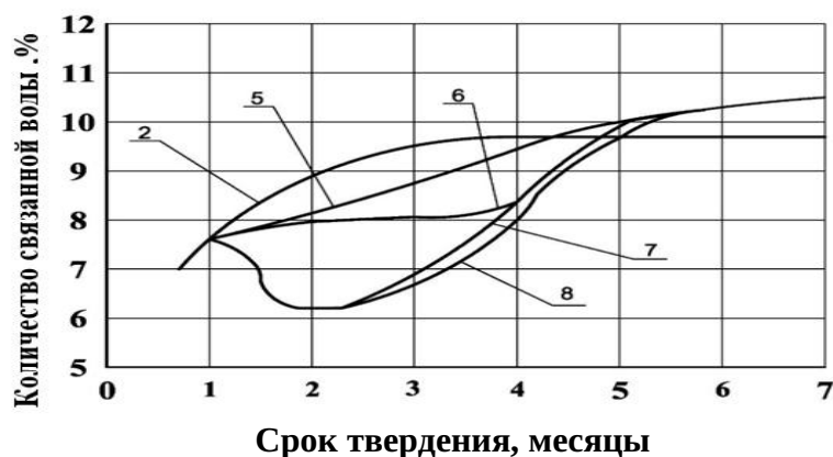
Рисунок 5 – Кинетика изменения количества прочносвязанной воды в белитовом цементном камне в процессе твердения при различных температурах, где 2 – постоянно в нормальных условиях, 5, 6, 7 и 8 – в начале один месяц в нормальных условиях, затем три месяца при температурах +5, 0, -5 и -10 °C и опять в нормальных условиях.
