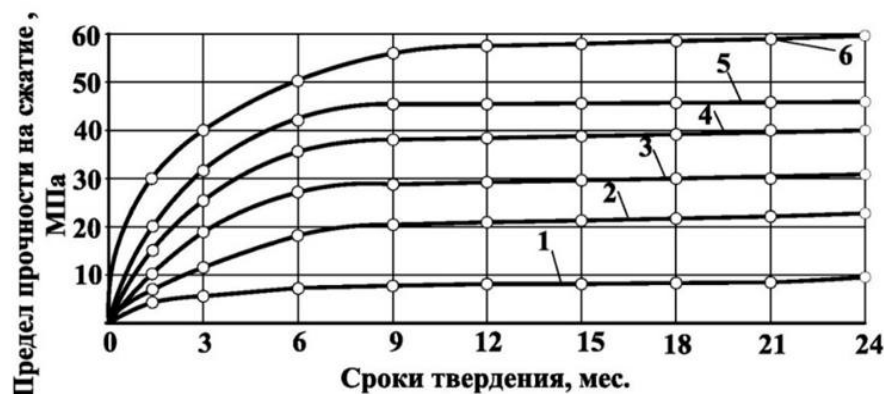
Рисунок 2 – Кинетика набора прочности дорожного бетона (ГПС) во времени от количества белитового цемента, где 1; 2; 3; 4; 5 и 6 – соответственно 5; 10; 15; 20; 25 и 30 мас.% цемента с содержанием белита C_2S – 75-80%.
