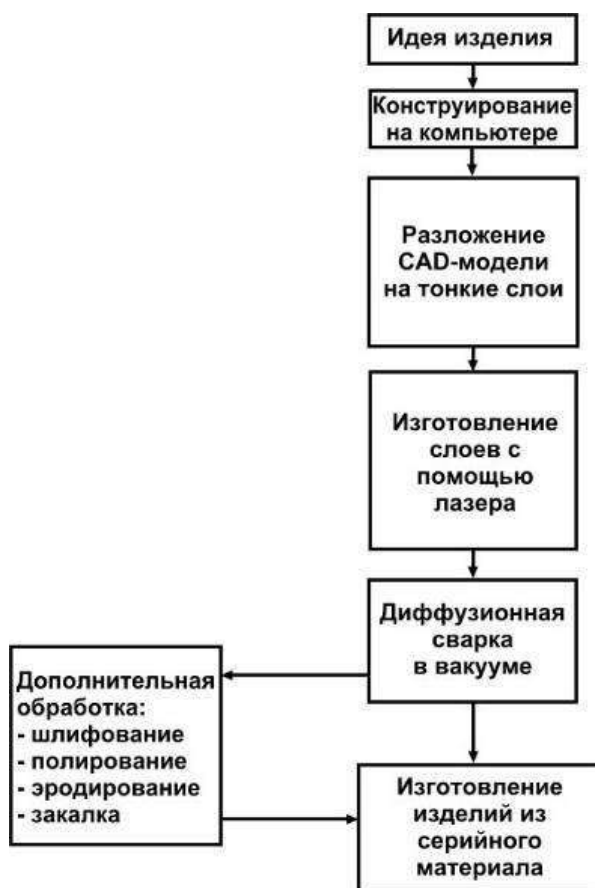
Рисунок 4 – Алгоритм создания пресс-форм из листовых порошковых материалов
