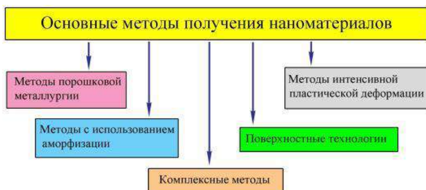
Рисунок 1 – Основные методы получения наноматериалов
