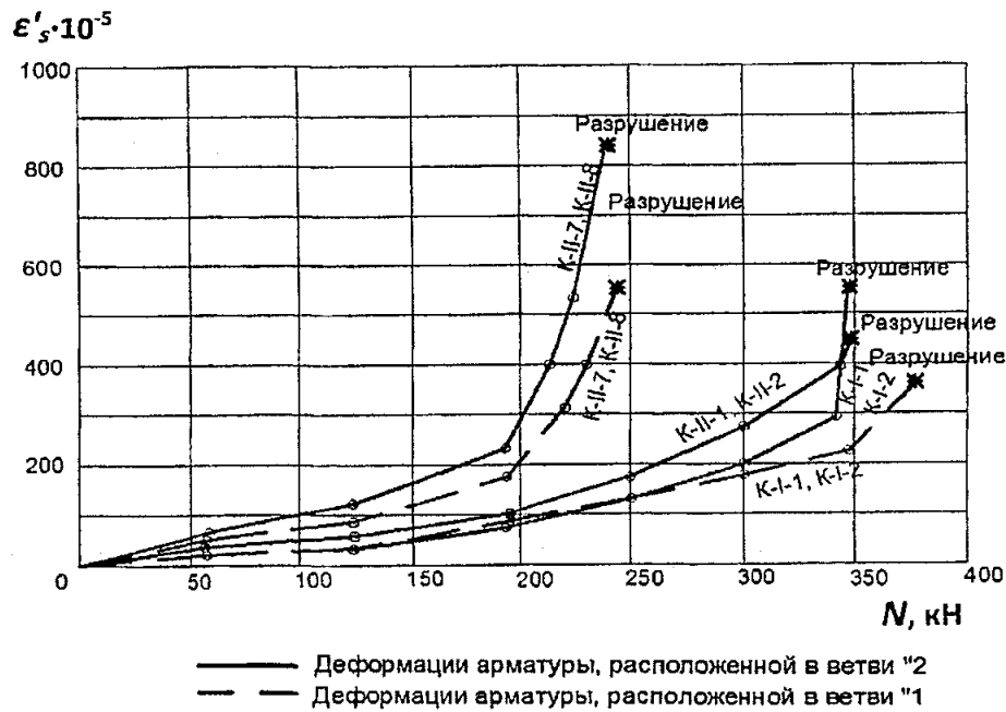
Рис. 11. Развитие деформаций \varepsilon_s' в наиболее сжатой арматуре опытных образцов
