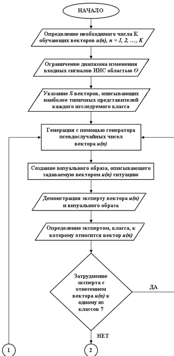
Рис. 2. Блок-схема алгоритма формирования массива обучающих пар «стимул-реакция» (начало)
