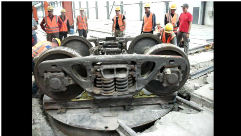
Рис.12. Поворот тележки на круге
