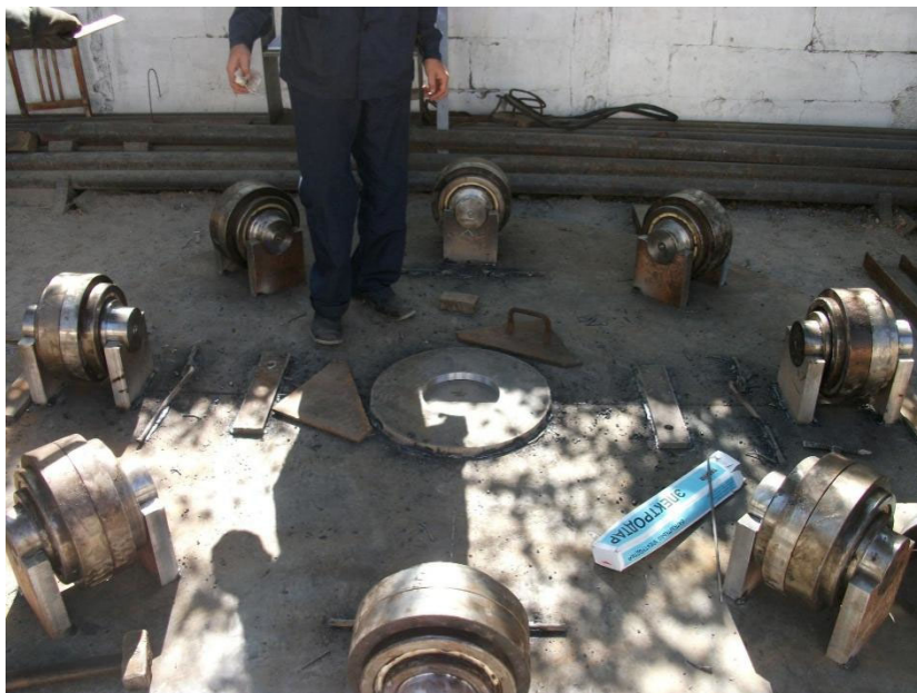
Рис.8. Изготовление поворотного круга
