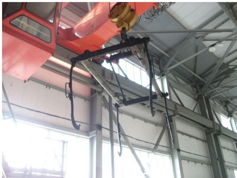
Рис.4. Захват для тележек
