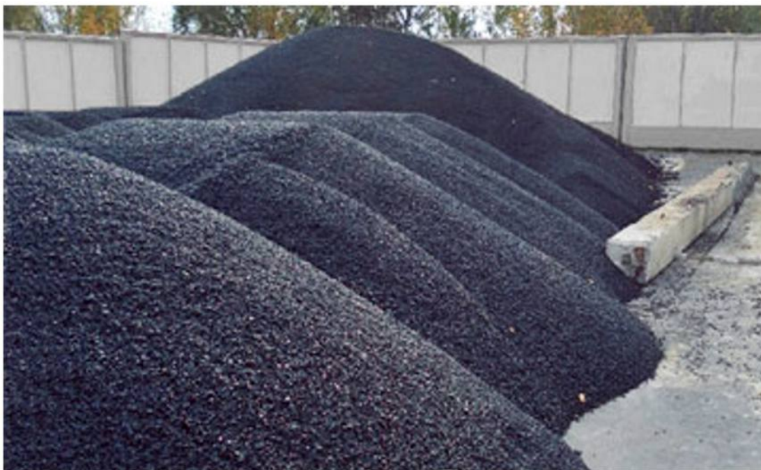
Рисунок 2 – Гранулят старого асфальтобетона (материал, полученный после дробления на валковой дробилке)
