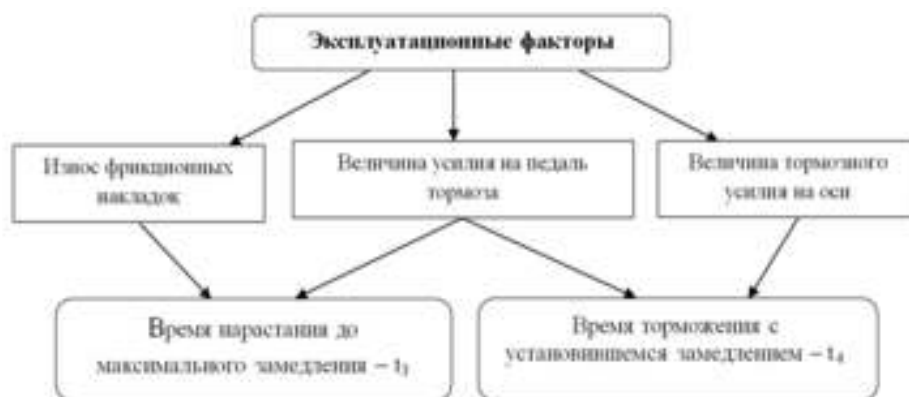
Рисунок 2 – Эксплуатационные факторы, влияющие на время срабатывания тормозной системы
