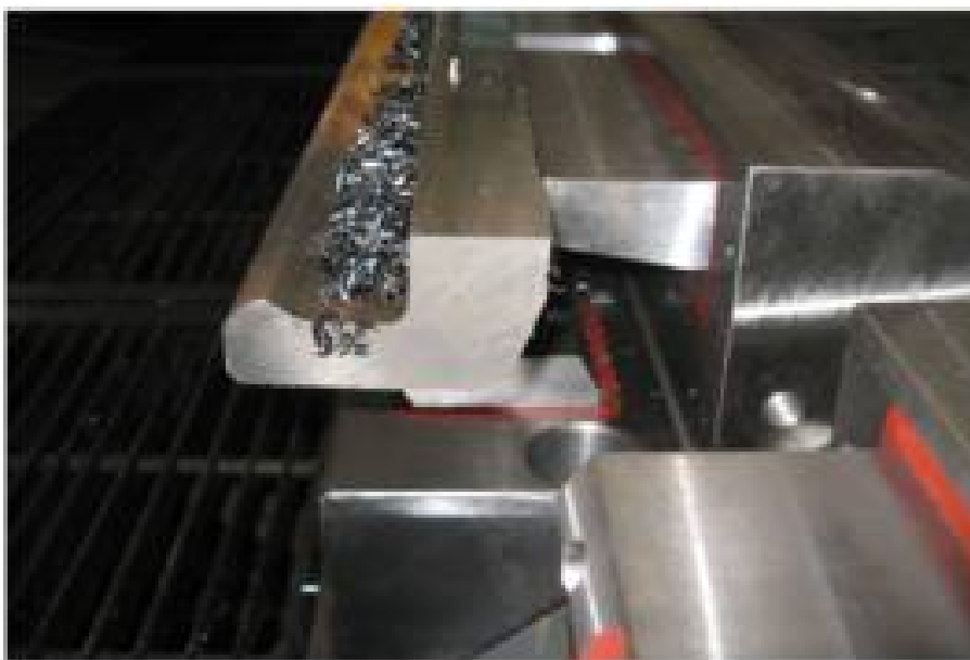
Рисунок 6 – Фрезерование контрельсового уголка на магнитном приспособлении
