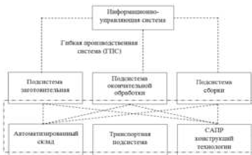
Рисунок 1 – Структура и технические элементы информационно-управляющей системы ГПС
