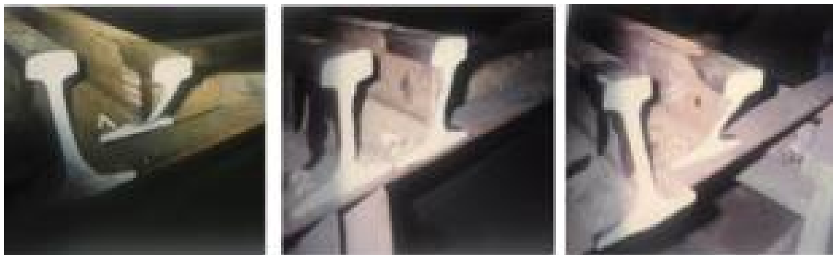
Рисунок 3 – Сечение рельсовых проб после наплавки по комбинированному технологическому методу
