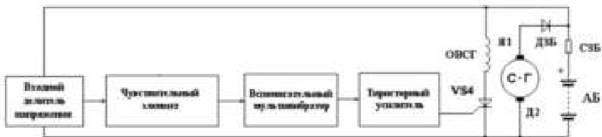
Рисунок 1 – Функциональная блок-схема регулятора напряжения РНТ-6
