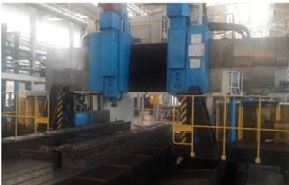
Рисунок 1 – Продольно-фрезерный станок с ЧПУ модели МС620ГМФ12К2
