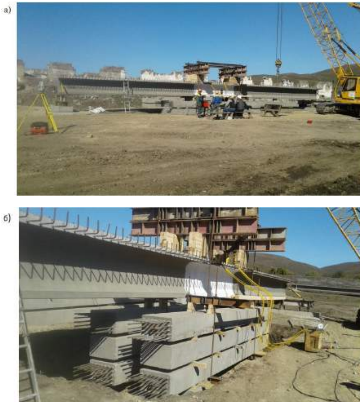
Рисунок 4 – Общий вид испытываемой балки ВТК-24У (а) и силового стенда с системой противовесов (б)
